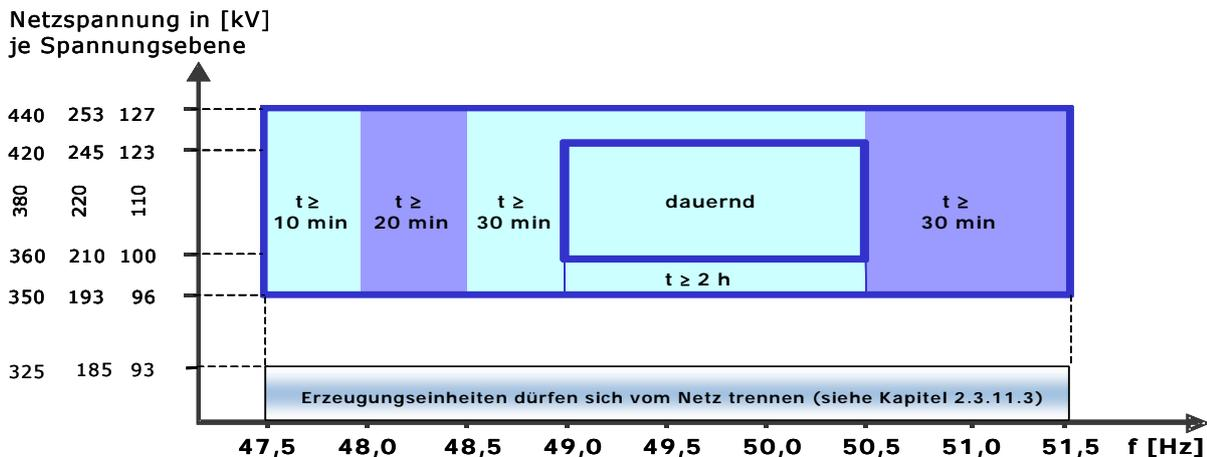
**Bild 3.1: Anforderungen an die Abgabeleistung der *Erzeugungseinheiten* an das Netz für bestimmte Zeitdauern in Abhängigkeit von Netzfrequenz und Netzspannung (quasistationäre Betrachtung, d. h. Frequenzgradient  $\leq 0,5$  %/min; Spannungsgradient 5 %/min)**
